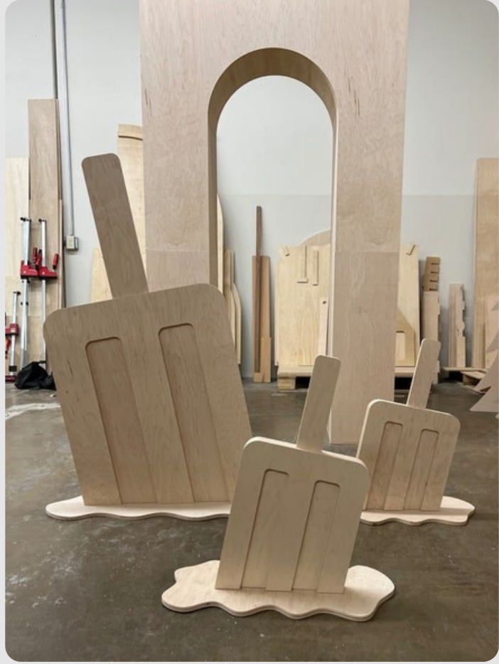
Görseldeki Dondurma tasarımı CNC Kesim kullanılarak üretilmiştir. Sonradan Sprey Boya uygulaması yapılmıştır.
